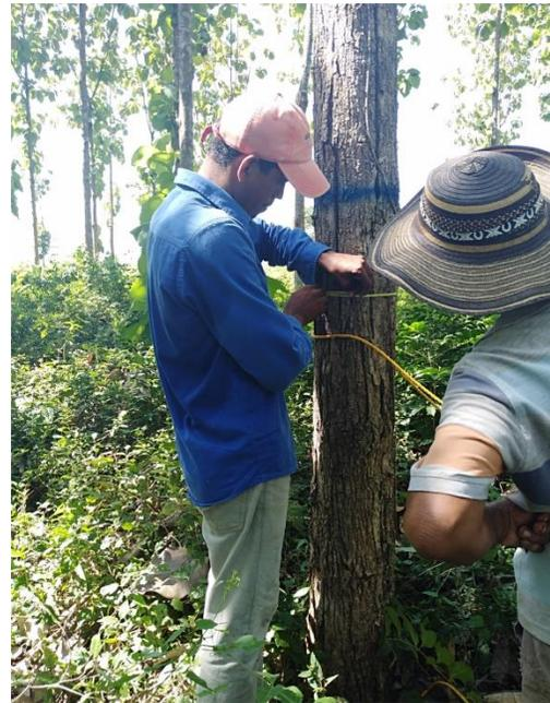
**Fotografías 3 y 4.** Medición del diámetro a la altura del pecho (DAP), utilizando cinta diamétrica en los árboles en las parcelas de muestreo del proyecto la Esperanza.
